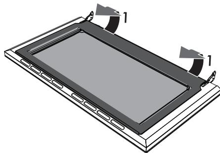
4. Выньте внутреннее стекло из передней рамки (2), чтобы снять его с дверки.
