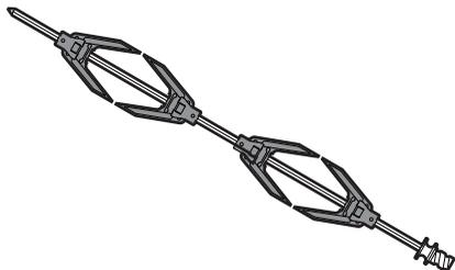
4. После того, как шток шампура будет подготовлен, установите его на соответствующие опоры. Вставьте конец штока в гнездо механизма, расположенного на левой опоре, до упора.
