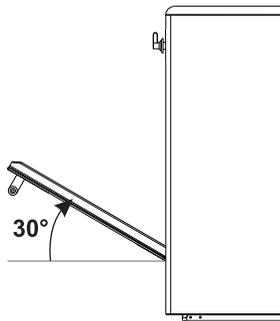
3. Чтобы снова установить дверцу, вставьте шарниры в соответствующие пазы, расположенные на духовке, так чтобы шлицы **A** полностью вошли в пазы. Опустите дверцу вниз, установите ее и извлеките штифты из отверстий шарниров.
