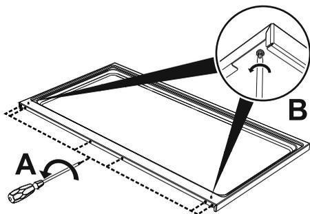
2. Установите планку на поверхности панели. Совместите 6 отверстий в нижней части доборной планки с 6 ранее ослабленными винтами в задней части панели.
