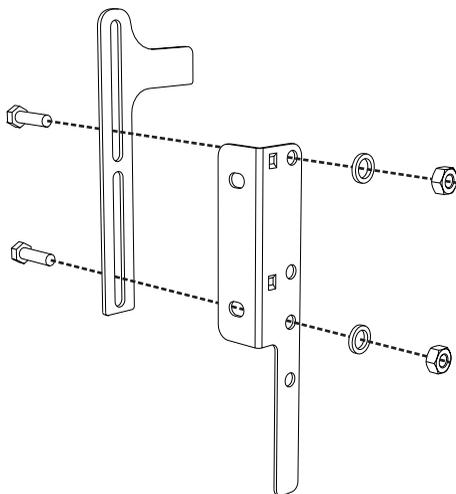
4. Выровняйте основу крюка крепежной скобы с основой отверстия пластины крепления к стене.
